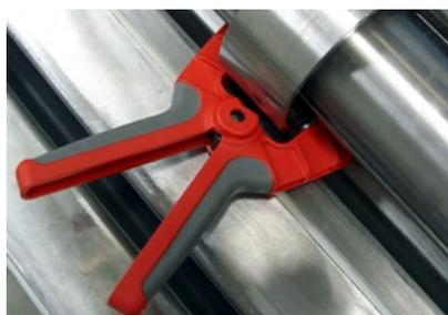
Die Haltezange reduziert eine Durchbiegung der Wellen.
