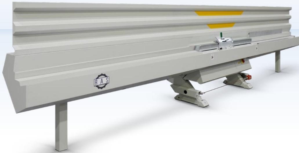
Der DuctZipper in L-Form ist speziell für große Kanalquerschnitte konzipiert. Die Arbeitslage ist um 45 Grad geschwenkt. Dadurch liegt der horizontale Schenkel des Kanals auf dem Tisch auf und der vertikale Schenkel ragt gerade nach oben. Griffmulden in der vertikalen Wand erlauben dem Bediener ein leichtes Halten und Führen des Kanals beim Durchlauf durch die Maschine.
