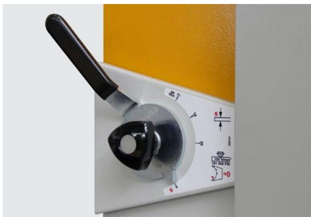
Hebel für die Schnittspaltverstellung an der PRIMEcut.
