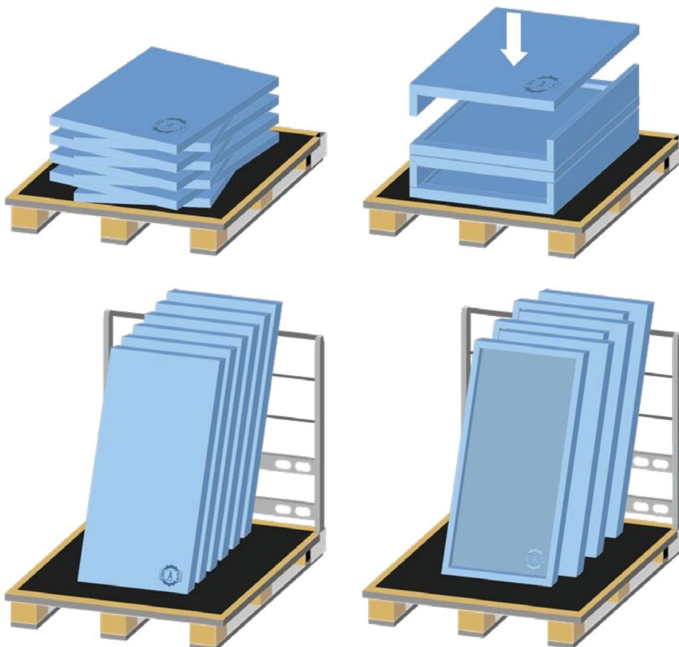
Stapelarten durch den Entlade-Roboter (Beispiele)
