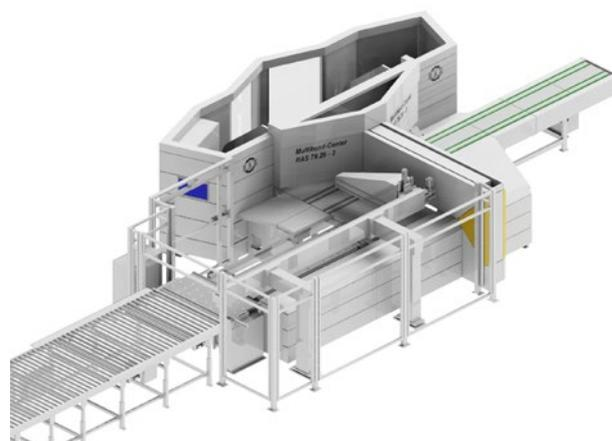
Multiband-Center mit Teilezufuhr über Rollengang und Beladung durch MiniFeeder.
