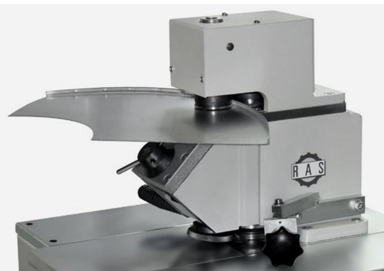
Mit den Umformrollen lassen sich unterschiedliche Bordhöhen erzeugen – passend zur gewünschten Falzverbindung
