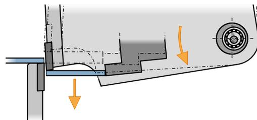
Die Schwenkbewegung des Messerbalkens verhindert ein Verklemmen des Zuschnitts zwischen Untermesser und Hinteranschlag.
