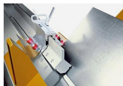
Autopilot und verstärkter Falzbalken beim DuctZipper RAS 20.12
