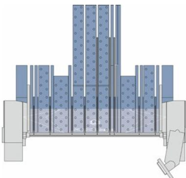
Rechteckanschlag oder T-Anschlag. Der Winkelanschlag erleichtert das stirnseitige Positionieren langer und schmaler Biegeteile.
