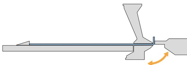
Der lange Schenkel des Biegeteils verbleibt auf dem Maschinentisch, die kurzen Schenkel werden gebogen.
