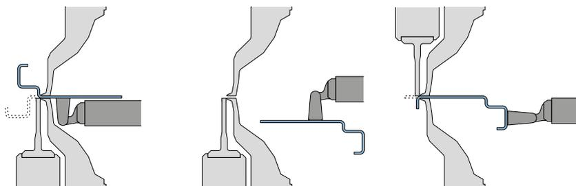
Automatisches Biegen komplexer Profile ohne Bedieneingriff. Das einzigartige FlexGripper Handlingsystem verändert im Arbeitsablauf bei Bedarf automatisch seine Greifposition.
