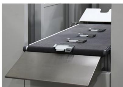
Biegeteile, die nicht stapelbar sind, können über das Auslaufband ausgeschleust werden.
