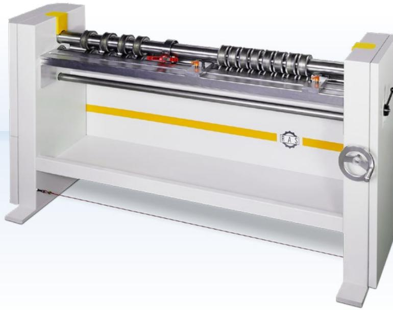
Der VENTIrounder rundet Innen- und Außenbögen von Luftkanälen mit vorher anprofilierten Falzen. Die segmentierten und verschiebbaren Umformrollen runden den Kanalbogen, ohne die Falze plattzudrücken.
