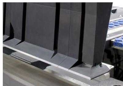
Höchste Biegequalität durch die patentierte Wange-in-Wange Biegewangenkonstruktion.
