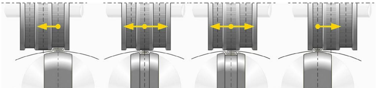
Zum Schließen von Rohrfalzen mit Aussen- und Innenfalz
