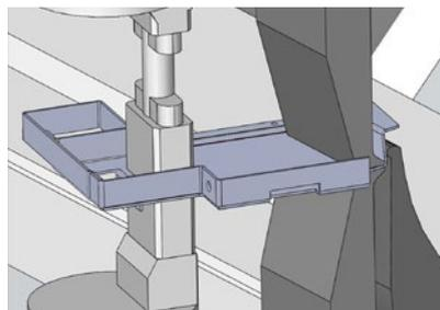
Einfache Office-Programmierung ausgehend von einer STEP-Datei des Biegeteils mit 3D Visualisierung der Biegeabläufe.
