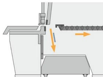
Anschnitte und Besäumstreifen fallen in den großvolumigen Schrottwagen. Er lässt sich seitlich oder nach hinten aus der Maschine ziehen.
