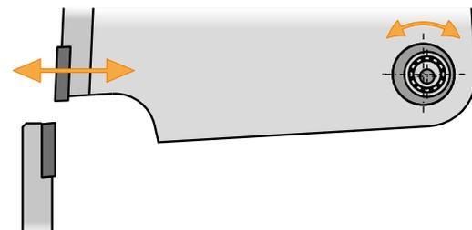
Die Schnittspalteinstellung erfolgt mühelos durch einfaches Verdrehen des Schnittspaltexzentrers.
