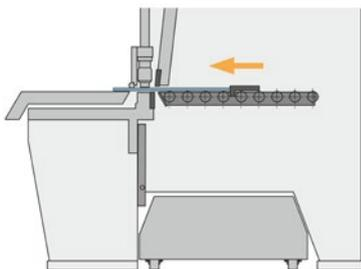
Zeitersparnis durch Rücktransport des Schnittguts zurück zum Bediener.
