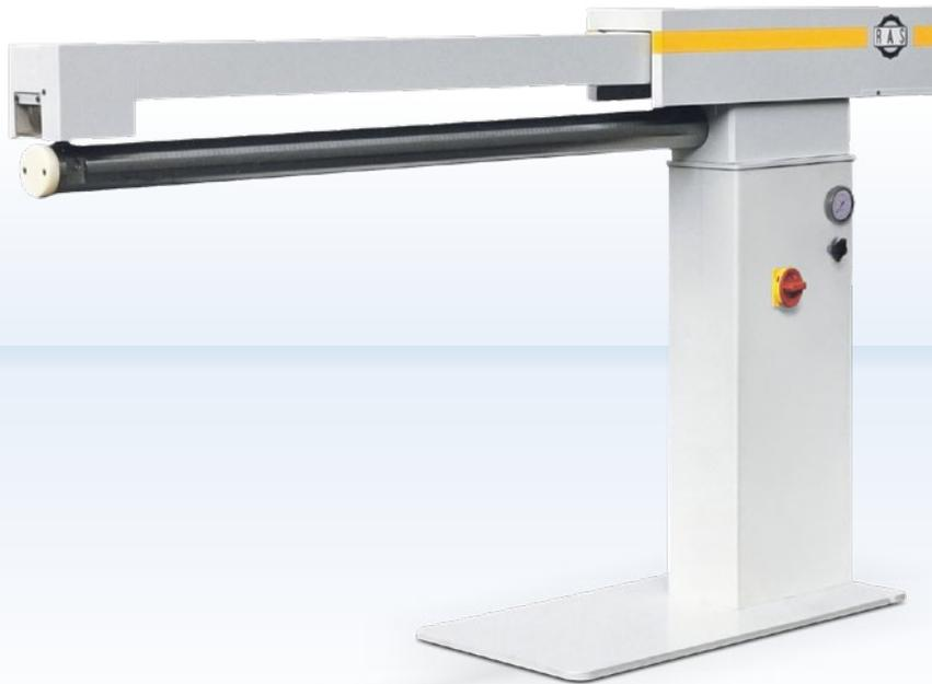
Die Falzzudrückmaschine schließt Rohrfalze mit Breiten von 10 mm und 13 mm an runden Rohren. Das Umstellen von Außen- auf Innenfalz erfolgt in Sekunden. Durch Drehen des Rohres verdoppelt sich die Nutzlänge.
