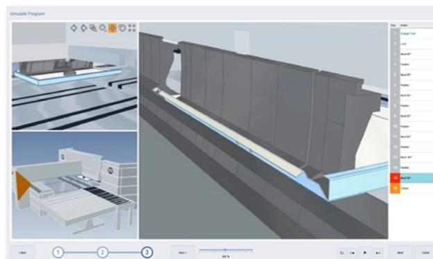
Die 3D Simulation zeigt den Biegeablauf und eventuelle Kollisionen. Neue Produkte lassen sich schon in der Konstruktion auf Machbarkeit prüfen.
