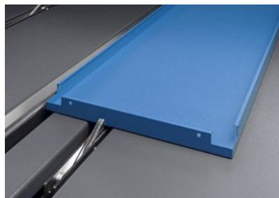
Lange, schmale Biegeteile am Winkelanschlag ausgerichtet.
