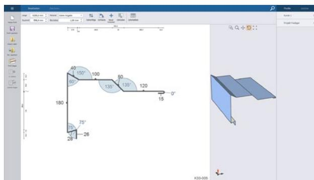
Zeichnen eines Profils am Touch-Monitor. Automatisches Programmieren des Biegeablaufs mit nur einem Mausklick. Keine Expertenkenntnisse erforderlich. Neue Biegeprofile lassen sich mit der Office-Software schon im Büro auf Machbarkeit prüfen.
