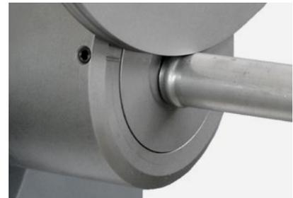
Schlauchsicke für Hydraulikrohre
