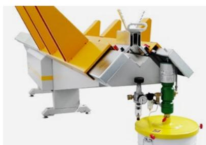
DuctZipper mit SealJet für maximal dichte Kanäle
