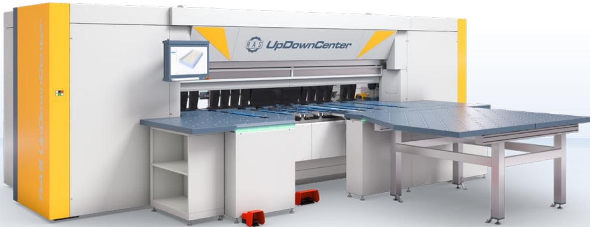
Das RAS UpDownCenter-2 biegt Bleche bis 4 mm Dicke, bis 4060 mm Biegelänge und einer max. Werkzeughöhe von bis zu 600 mm.
