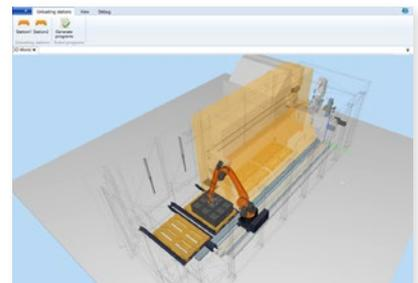
Die Generierung der optimalen Stapel-Routine eines Fertigteils auf der Palette erfolgt durch das RASpall-Programm.
