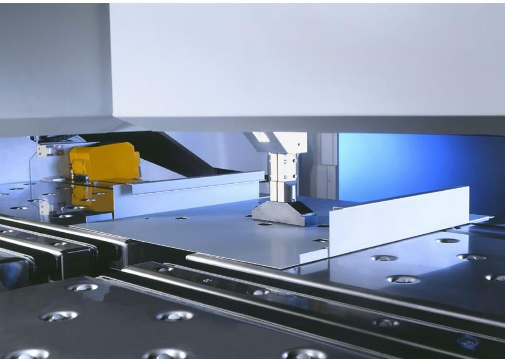
Manipulator zum Drehen und Positionieren der Biegeteile
