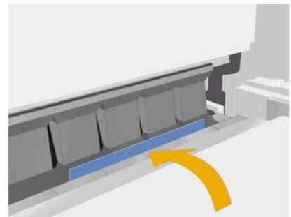
Ablauf des Schwenkbiegeprozess: Platine positionieren – spannen – biegen
