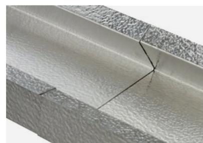
Exakte Paßgenauigkeit ohne Programmieraufwand bei ineinander steckbaren Profilen (konisch biegen).
