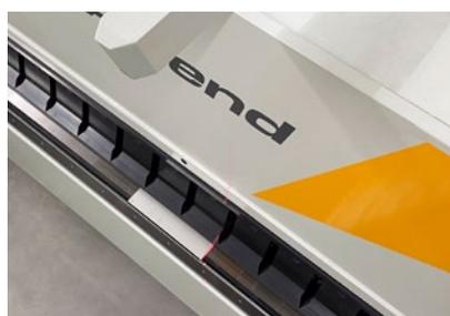
Der ViN zeigt mit einem Laserstrahl die exakte seitliche Einlegeposition des Biegeteils an.
