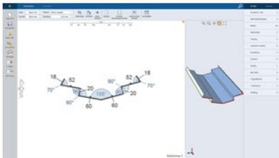
Zeichnen eines Profils am Touch-Monitor. Automatisches Programmieren des Biegeablaufs mit nur einem Mausklick. Keine Expertenkenntnisse erforderlich. Neue Biegeprofile lassen sich schon im Büro auf Machbarkeit prüfen.
