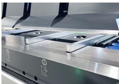
Die Anschlagfinger können bis auf 20 mm an die Biegelinie heranfahren und damit auch sehr schmale Teile positionieren.
