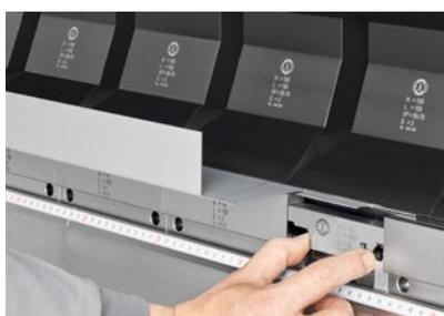
Mit Hilfe der DownTools lassen sich nach innen versetzte Biegungen ohne separaten Werkzeugaufbau erzeugen.
