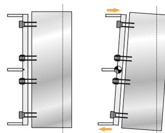
Durch Schrägstellung des Anschlags können konische Teile erstellt werden.
