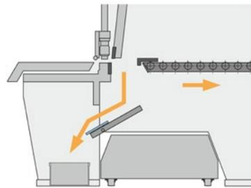
Kleinteile bis 200 x 500 mm können im Schneidablauf in einen Behälter vor der Maschine sortiert werden.
