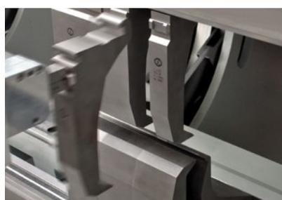
Der automatische Werkzeugwechsel erlaubt einen schnellen Teilewechsel und das Biegen kleiner Losgrößen.
