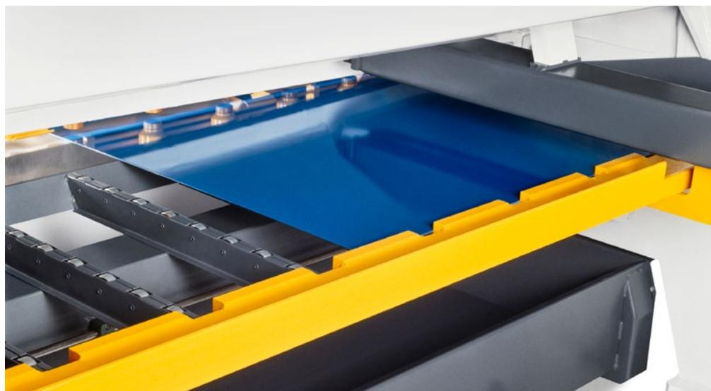
Das Hochhaltesystem führt auch dünne Bleche maßgenau zum CNC-Hinteranschlag.
