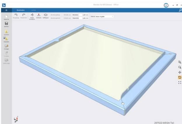
Die Bendex Software importiert eine Step-Datei des Biegeteils und programmiert daraus automatisch den Biegeablauf.
