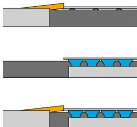
Das 3 in 1-Anschlagsystem erlaubt die Positionierung der Biegeteile durch Anschlagfinger, Sauger oder einer Kombination aus beiden.
