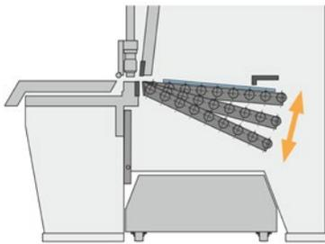
Nach dem Schnitt schwenkt das Hochhaltesystem in vier mögliche Ablagepositionen.
