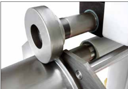
Bördelwalzen FL: Flanschen ohne Hochschwenken des Teils
