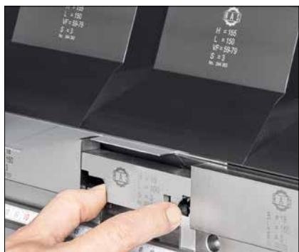
Das DownTool in der Biegewange wird einfach von Hand abgeklappt.
