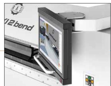
Schwenkbare Steuerung zur Bedienung der Maschine von der Biegewangen oder der Anschlagseite.
