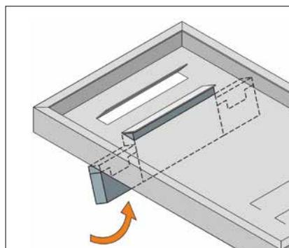
Mit den DownTools lassen sich Kiemen, mehrseitige Teile und nach innen gebogene Schenkel ohne zusätzlichen Werkzeugaufbau biegen.
