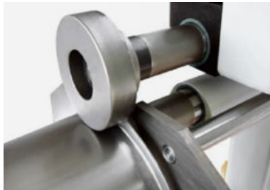
Bördelwalzen FL: Flanschen ohne Hochschwenken des Teils
