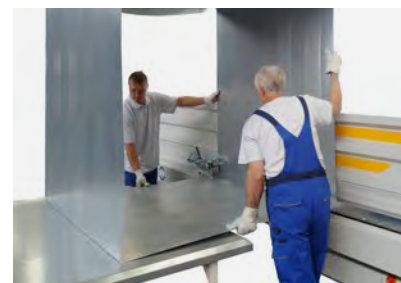
Die Fertigung sehr großer Kanäle ist mit nur zwei Bedienern möglich.
