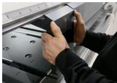
Schnelle Rüstvorgänge durch ein automatisches Spannen der Werkzeuge.
