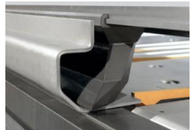
Oberwangenwerkzeug mit großem Freibereich auf der Vorderseite.
