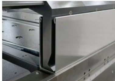
Große Gestaltungsfreiheit für die Biegeteile durch schlanke aber stabile Werkzeuge.
