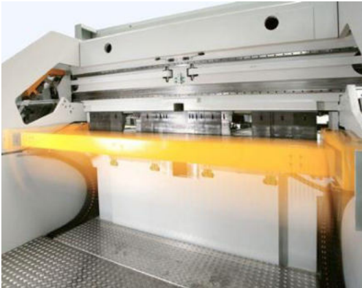
Vollautomatische Biegeabläufe: Positionieren, Drehen, Biegen und Werkzeugwechsel
