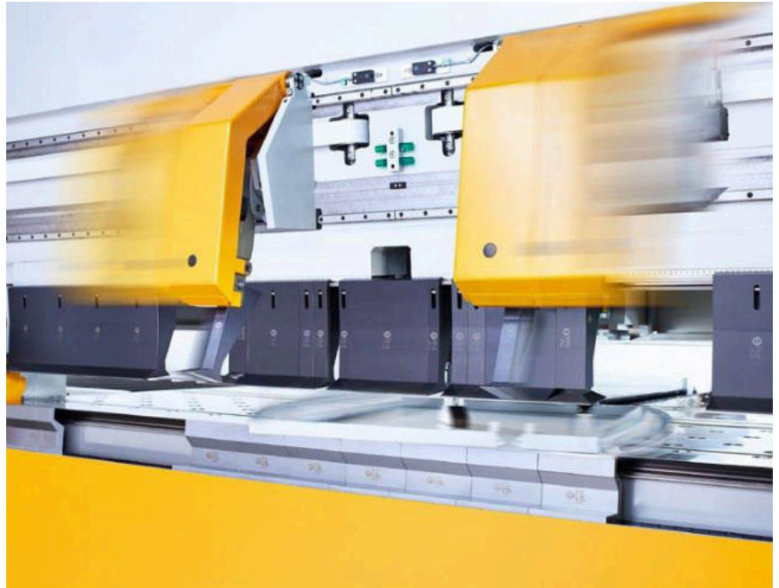
Vollautomatische Biegeabläufe: Positionieren, Drehen, Biegen und Werkzeugwechsel
