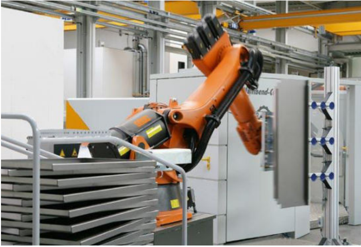
Wendestation für Fertigteile
