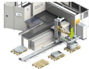
Horizontales Stapeln eines Biegeteils auf einer Palette
