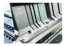
Die SnapTools mit klappbarer Sohle tauchen automatisch aus Teilen mit seitlichen Biegeschenkeln aus.
