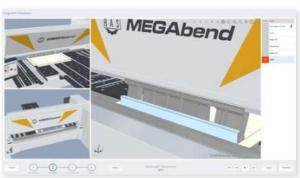
Eine 3D-Simulation zeigt den Biegeablauf, den Werkzeugaufbau und die Einlegesituation des Biegeteils.
