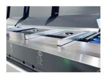
Die Anschlagfinger können bis auf 20 mm an die Biegelinie heranfahren und damit auch sehr schmale Teile positionieren.
