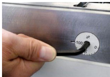
Einstellung des CrownTools zum Bombieren des Biegewangen-Werkzeugs (speziell beim Stepbiegen von Radien).
