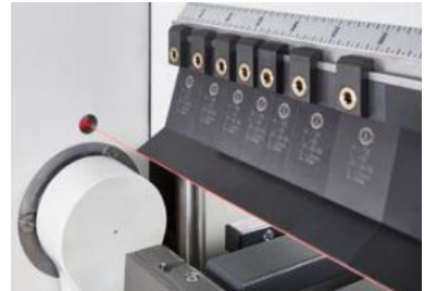
Ein Laser ermittelt automatisch die exakte Werkzeughöhe.
