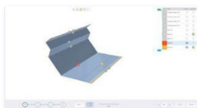
Automatisches Programmieren des Biegeablaufs mit der Grafiksoftware.
