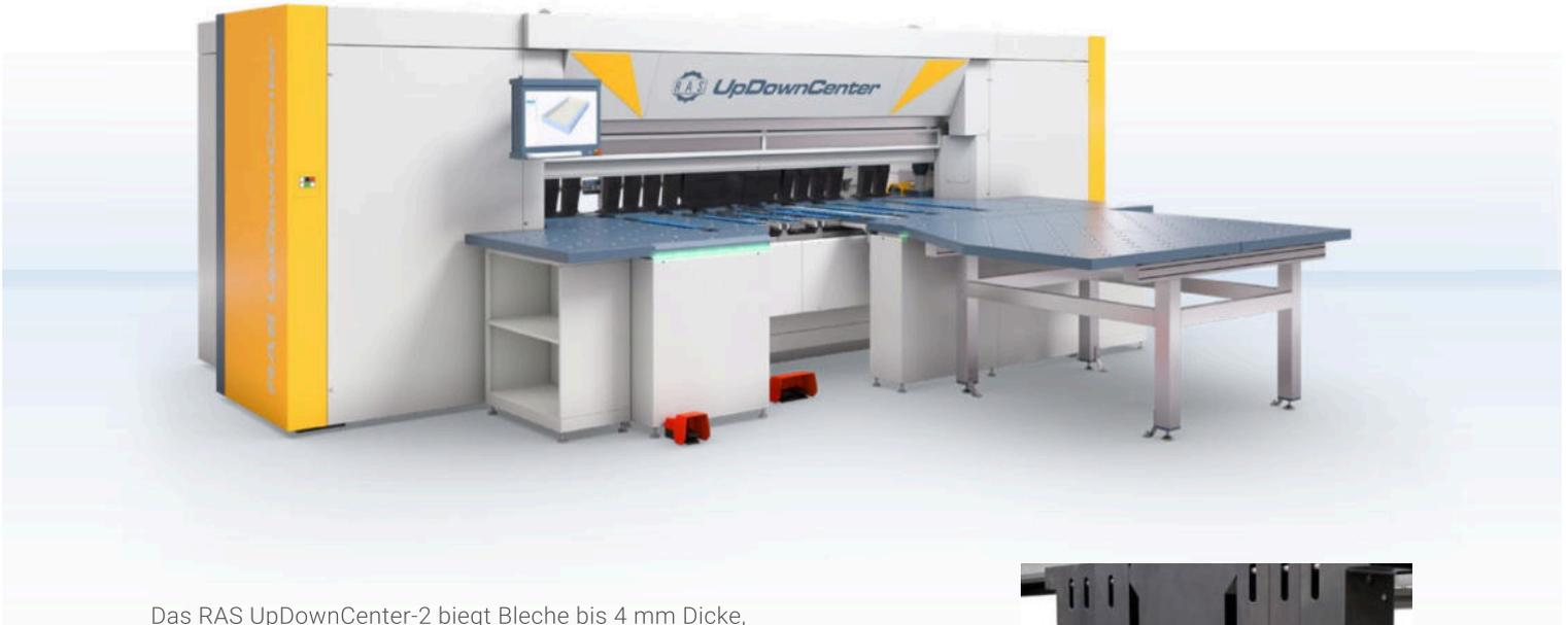
Das RAS UpDownCenter-2 biegt Bleche bis 4 mm Dicke, bis 4060 mm Biegelänge und einer max. Werkzeughöhe von bis zu 600 mm.
