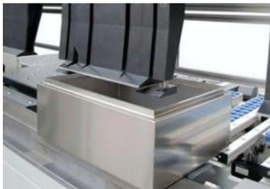
Oberwangenwerkzeuge für Boxen mit einer Höhe bis zu 600 mm.
