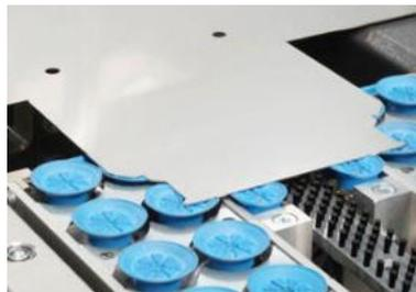
Kleinteilesauger erlauben ein sicheres Positionieren kleiner Platinen.
