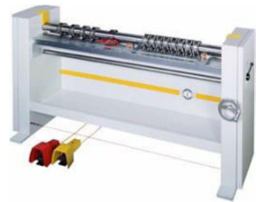
Fußschalter für variable Geschwindigkeit und zum Richtungswechsel.
