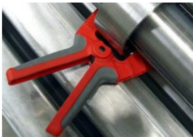
Die Haltezange reduziert eine Durchbiegung der Wellen.
