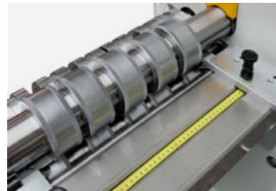
Maßband für eine schnelle Voreinstellung.
