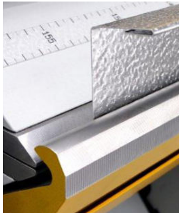
Kein Wenden der Biegeteile erforderlich, da die Maschine nach oben und unten biegt. Hohe Produktivität durch schnelle Biegeabläufe.
