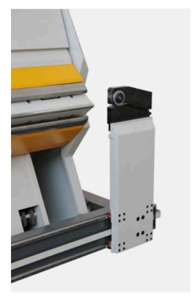
CutModul zum Besäumen von zu breiten Zuschnitten. Automatische Abfolge beim Schneiden und Biegen
