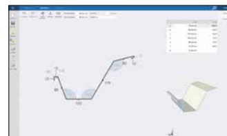
Werkzeuge mit Radius für das Biegen von Aluminium.
