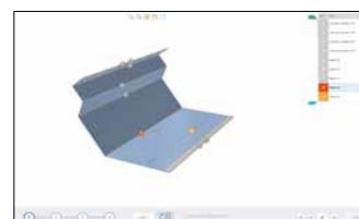
Automatisches Programmieren des Biegeablaufs mit der Grafiksoftware
