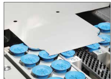
Kleinteilesauger erlauben ein sicheres Positionieren kleiner Platinen.
