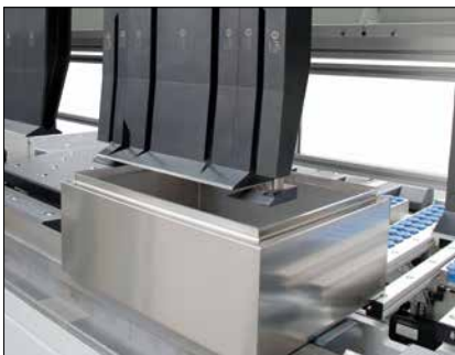
Oberwangenwerkzeuge für Boxen mit einer Höhe bis zu 600 mm.
