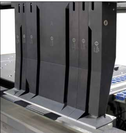
Nur ein Satz Oberwangenwerkzeuge (bis 600 mm Höhe) mit Ferse zum Zudrücken von Umschlägen für große Gestaltungs-Flexibilität. Biegen hoher vierseitiger Teile.
