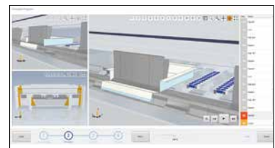
Die 3D Simulation zeigt den Biegeablauf und eventuelle Kollisionen. Neue Produkte lassen sich schon in der Konstruktion auf Machbarkeit prüfen.
