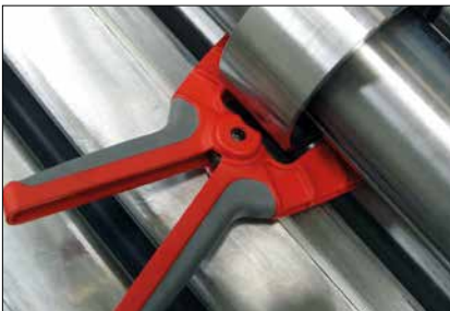
Die Haltezange reduziert eine Durchbiegung der Wellen.
