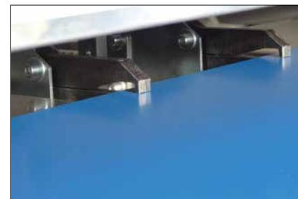
Greiferzangen positionieren das Biegeteil. Das sichert exakte Schenkelmaße und schnelle Biegeabläufe.
