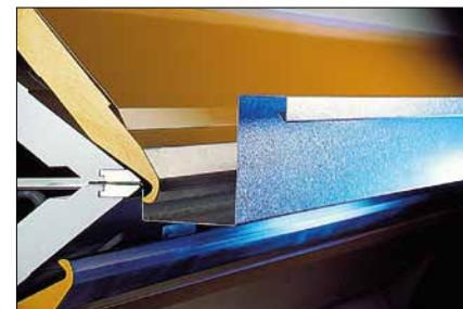
Kein Wenden der Biegeteile erforderlich, da die Maschine nach oben und unten biegt.
