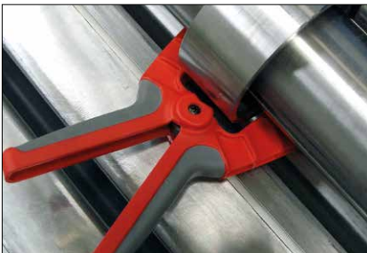
Die Haltezange reduziert eine Durchbiegung der Wellen.
