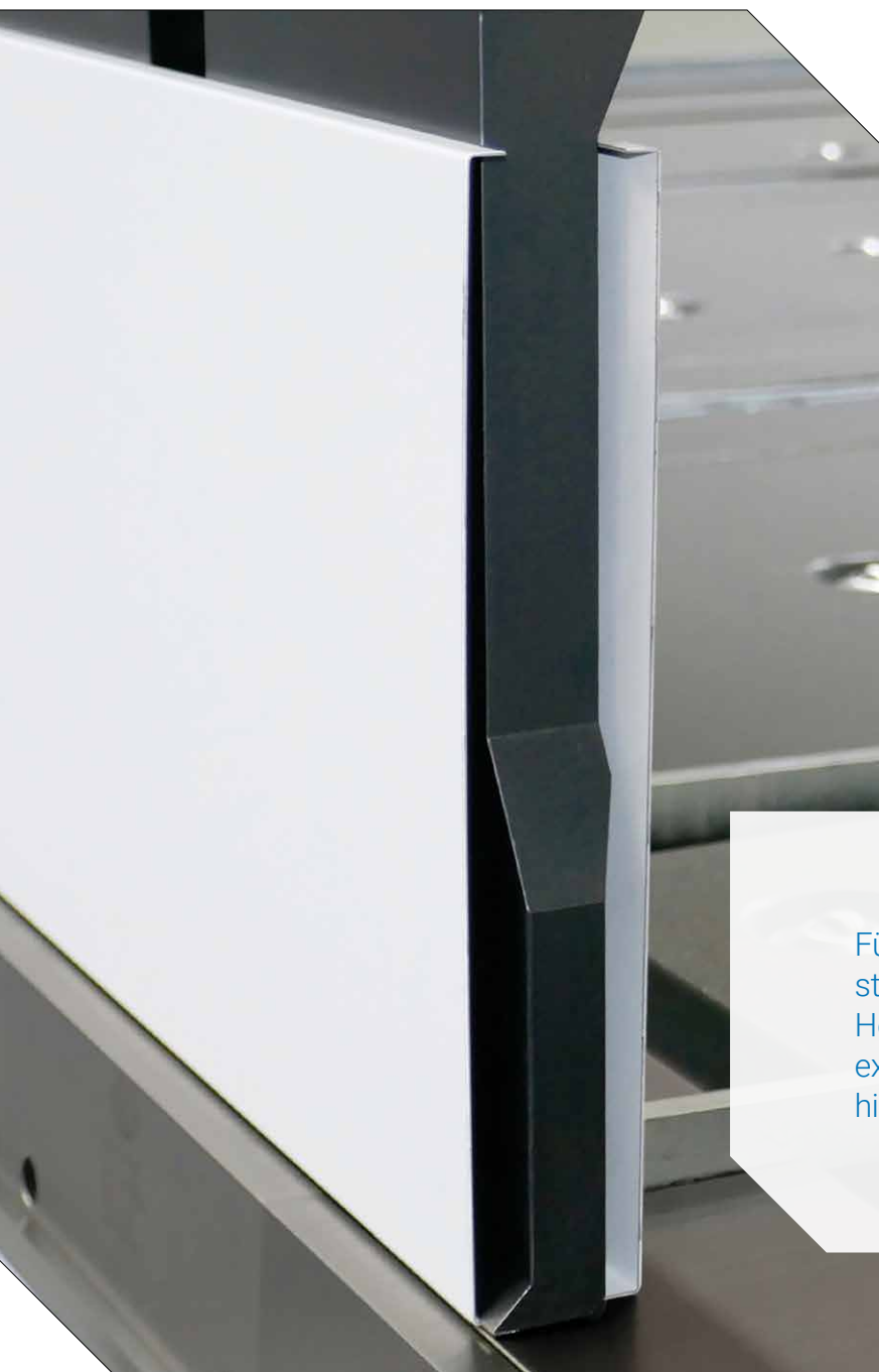
Die DownTools erlauben das Biegen unterbrochener Kanten ohne zweiten Werkzeugaufbau.
