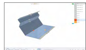
Automatisches Programmieren des Biegeablaufs mit der Grafiksoftware
