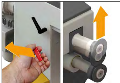
UnLock-Funktion öffnet die Wellen im Notfall
