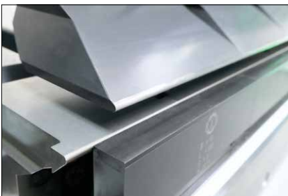
Manche Werkstoffe erfordern den Einsatz von Radiuswerkzeugen in der Ober- und Unterwange. Gepaart mit Biegewangenwerkzeugen mit Kunststoffeinsatz entstehen perfekte Oberflächen.
