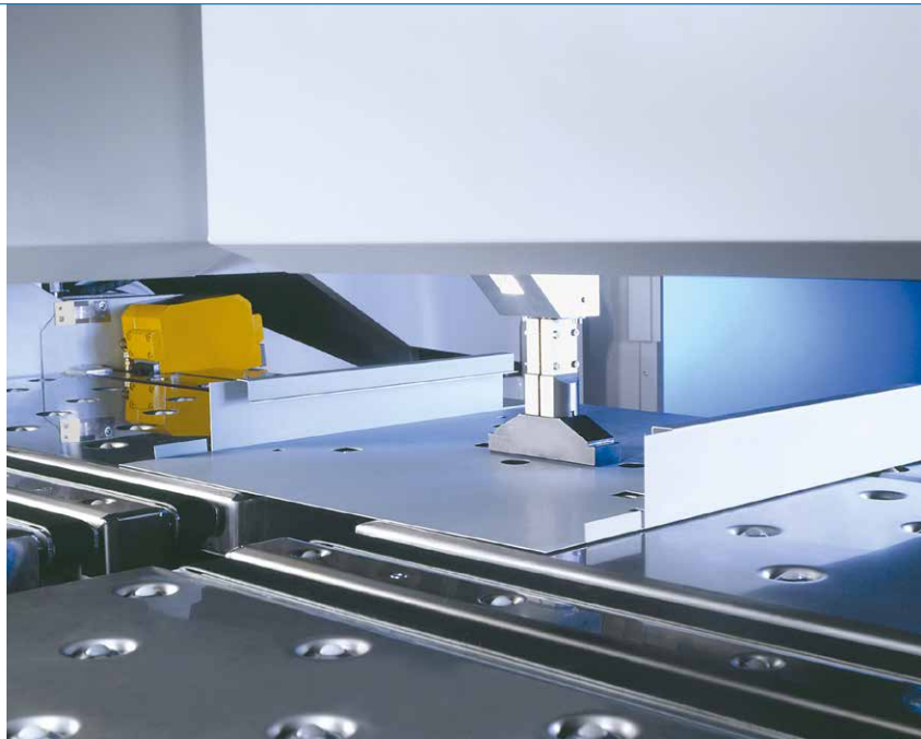
Manipulator zum Drehen und Positionieren der Biegeteile
