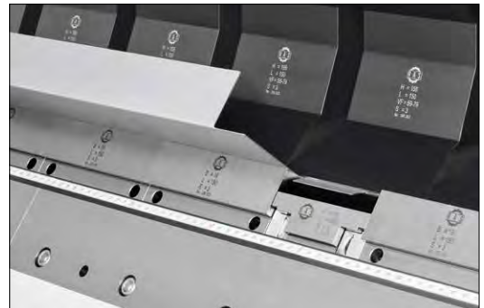
Die DownTools erlauben das Biegen unterbrochener Kanten ohne zweiten Werkzeugaufbau.
