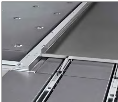
Sicheres Ausrichten langer, schmaler Biegeteile am aktiven Winkelanschlag.
