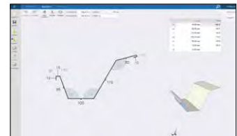
Werkzeuge mit Radius für das Biegen von Aluminium.
