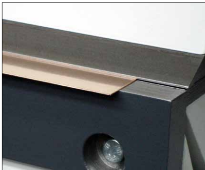
Automatische Biegewangeneinstellung für dünne und dicke Bleche.
