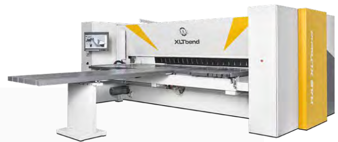
Höchste Biegequalität durch die patentierte Wange-in-Wange Biegewangenkonstruktion.
