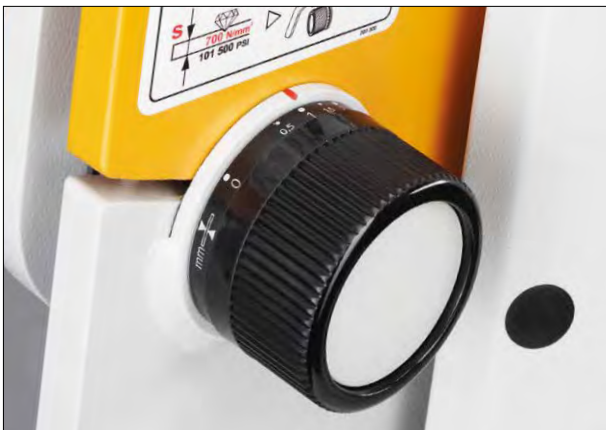
Mit einem Drehknopf lässt sich der Schnittspalt schnell und einfach auf die Blechdicke und Materialsorte einstellen.
