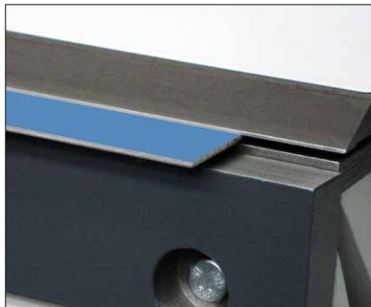
Automatische Biegewangeneinstellung für dünne und dicke Bleche.
