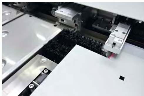
Magic-Eye Platinenscanner zum optischen Vermessen
