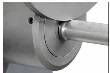
Schlauchsicke für Hydraulikrohre
