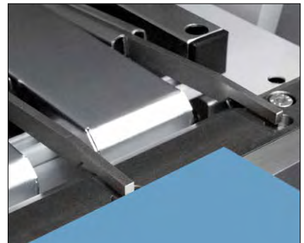
Anschlagfinger von Min- auf Maximalmaß unter 2 Sekunden.
