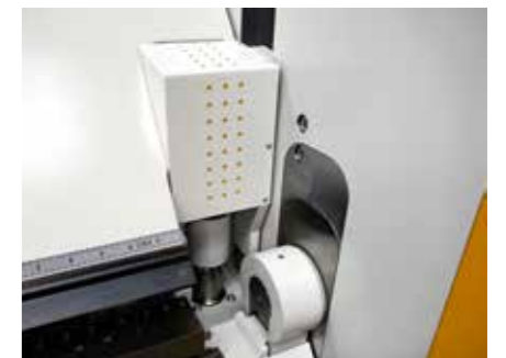
Les PowerBoosters serrent les tôles avec 120 tonnes de force de serrage et garantissent des plis droits.
