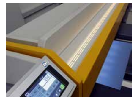
Alignement confortable de la tôle d'après traçage avec éclairage LED de la ligne de coupe
