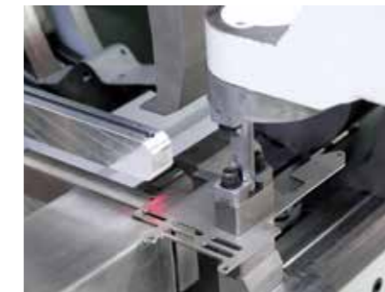
Mesurage de la tôle par un scanner laser.
