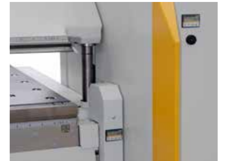
Affichage digital optionnel pour le réglage du tablier plieur et du sommier inférieur.
