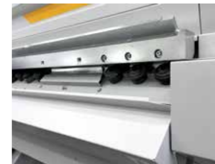
Galets de formage accessibles facilement pour travaux de maintenance.
