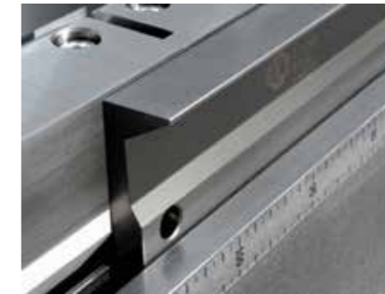
Grande liberté de design pour les pièces de pliage grâce aux outils fins mais robustes du tablier plieur.
