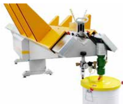
DuctZipper avec SealJet pour des conduits extrêmement étanches.
