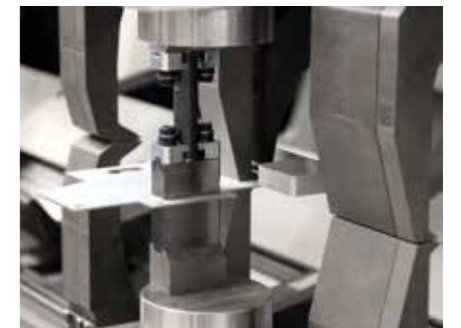
Le long de la ligne de pliage plusieurs stations de pliage peuvent être mises en place. Pièces de pliage complexes sont ainsi terminées en un passage.
