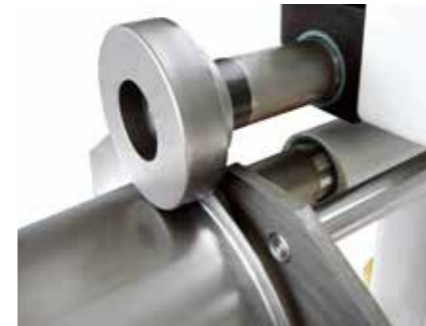
Galets à bords FL : production de brides sans pivotement vers le haut de la pièce.
