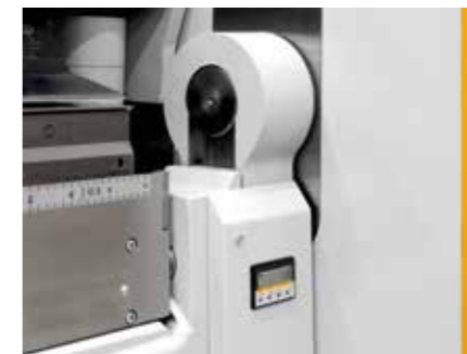
Affichage digital optionnel pour le réglage du tablier plieur.
