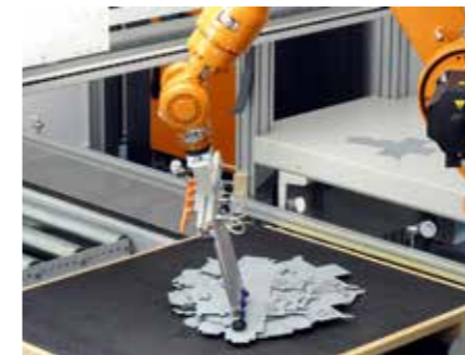
Le chargement par robot offre flexibilité maximale. Les tôles peuvent être fournies à partir d'un conteneur pour produits en vrac ou de piles de tôles.
