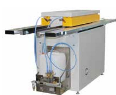
SpeedySeamer avec dispositif pulvérisateur pour le traitement d'acier inoxydable.
