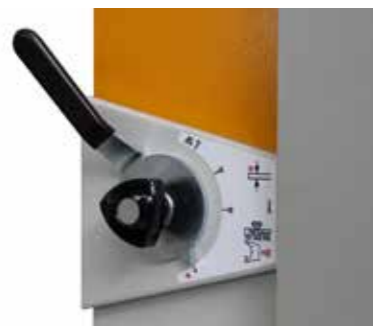
Levier pour réglage du jeu entre lames à la PRIMEcut.
