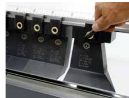
Outils avec système de bridage rapide
