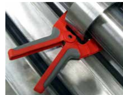
La pince de maintien empêche un fléchissement des arbres.
