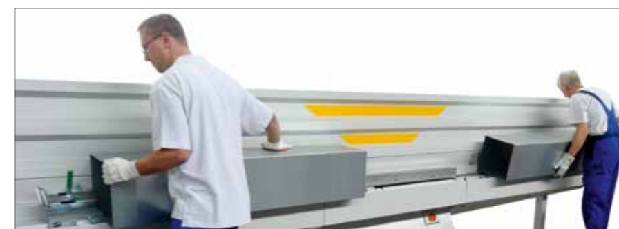
Vitesse de travail doublée: lorsque le premier conduit est terminé et retiré, l'opérateur serre l'autopilote sur le prochain conduit et déjà le prochain conduit d'air traverse la machine.
