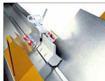
Autopilote et poutre d'agrafage renforcée au DuctZipper RAS 20.12
