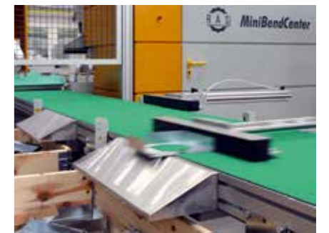
Evacuation des pièces pliées dans conteneur pour produits en vrac.
