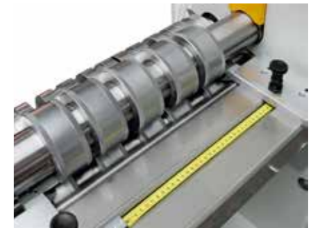
Mètre ruban pour un pré réglage rapide
