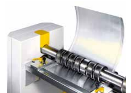
Bagues d'arbre adaptables à la largeur de la pièce
