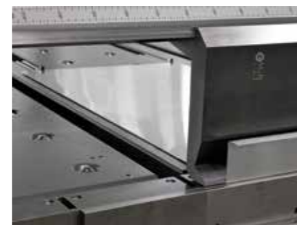
Pendant la séquence de pliage, la tôle reste sur la table de butée. Pas nécessaire de lever les pièces.
