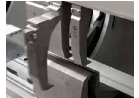
Le changement automatique des outils permet un changement rapide des pièces et le pliage de lots de petite taille.
