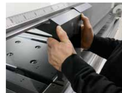
Mise en place rapide des outils grâce au serrage automatique des outils.
