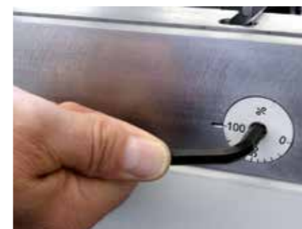
Ajustement du CrownTool pour le bombage de l'outil du tablier plieur.
