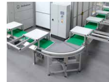
Déchargement approprié des pièces de pliage finies selon l'espace à disposition, le flux de matière et la sensibilité des pièces pliées.
