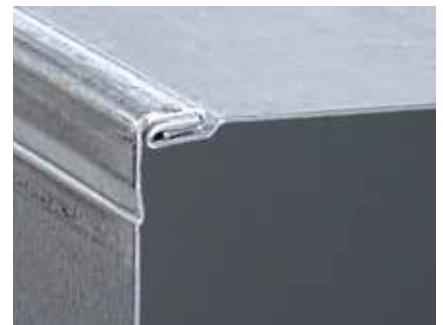
La precisión de unión mejorada también resulta en una reducción de la distorsión de la sección horizontal del conducto.
