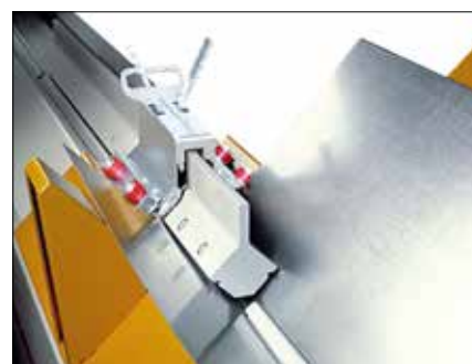
Pinza y barra de unión reforzada en la RAS 20.12 DuctZipper
