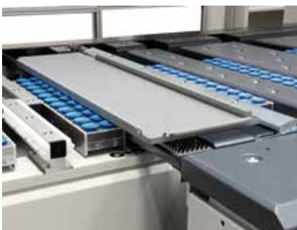
Alineación precisa de piezas largas y estrechas con el brazo escuadra activo.
