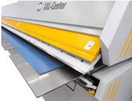
Secciones de mesa retráctiles para fácil carga y rotación de chapa.
