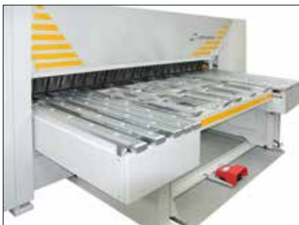
Sistema de topes traseros ampliado a su dimensión máxima.
