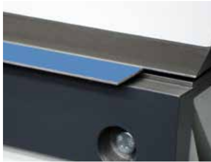
Ajuste automático de la trancha de plegado para materiales finos y gruesos
