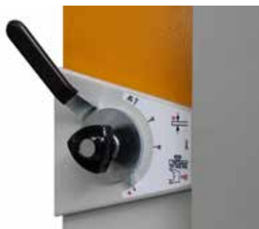
Palanca para ajuste de la apertura de corte en la PRIMEcut
