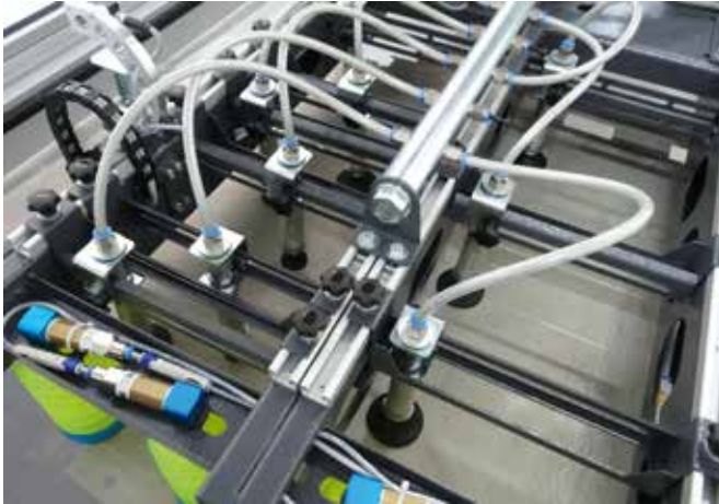
Armazón de succión del cargador tipo pórtico con 6 ventosas para despegar la chapa y 45 ventosas móviles.
