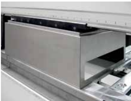
Las herramientas altas de la trancha superior permiten la producción de cajas profundas.
