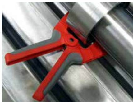
Alicates de apriete para radios consistentes.
