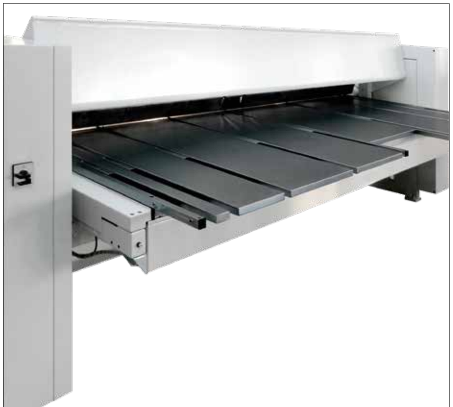
Parte trasera de la TURBObend plus con sistema de topes traseros rectangular
