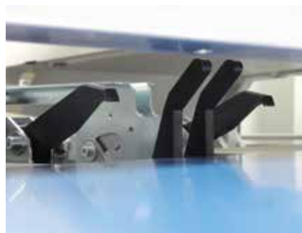
Precisión de plegado asegurada gracias a la alineación automática de las chapas.
