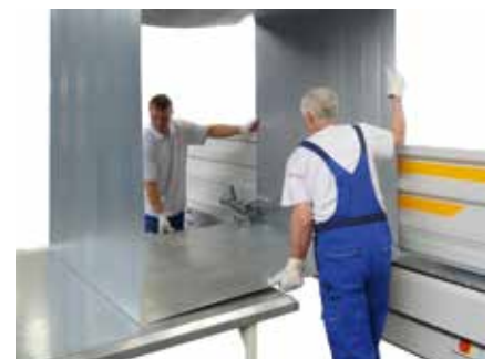
La precisión de unión mejorada también resulta en una reducción de la distorsión de la sección horizontal del conducto.
