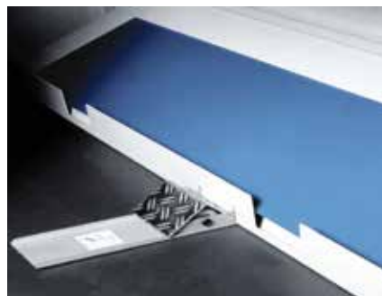
La palanca de pie cambia la dirección de la rampa de las piezas
