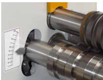
Escala para ajustes de radio
