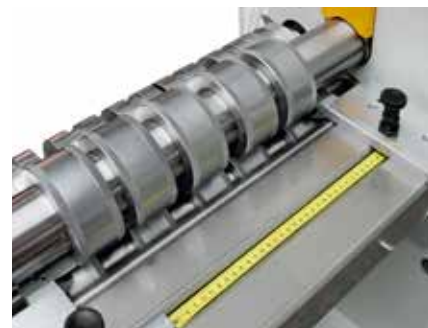
Cinta métrica para posicionamiento rápido del rodillo.
