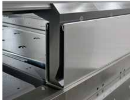
Flexibilidad de diseño de piezas debido a las herramientas estrechas pero rígidas.
