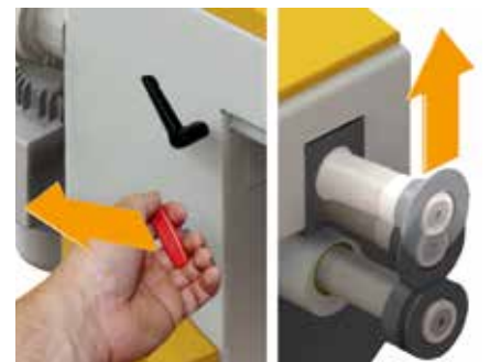
La función de desbloqueo abre los rodillos inmediatamente en caso de emergencia.
