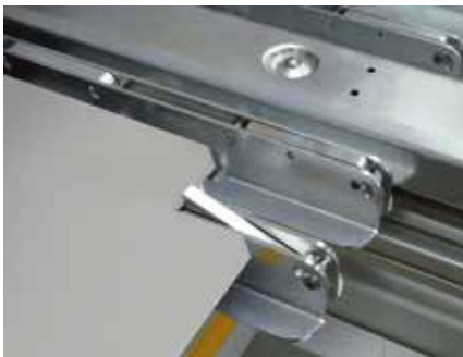
Posicionamiento flexible de la pieza. Los dedos de tope individuales pueden desactivarse.
