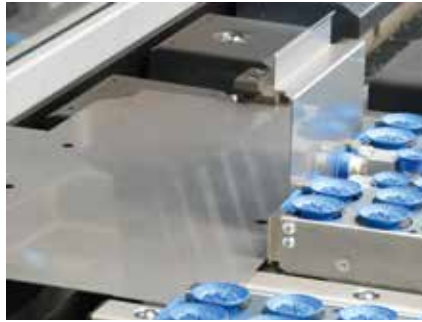
Alta flexibilidad en manipulación gracias a las ventosas de succión frontales y a las ventosas de succión para pequeñas piezas.
