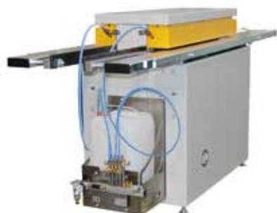
SpeedySeamer con unidad de spray lubricante para aplicaciones de acero inoxidable
