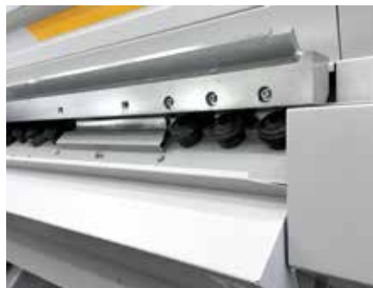
Rodillos de perfilado de acceso fácil para trabajos de mantenimiento
