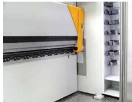
Trancha de plegado en posición 180 grados
