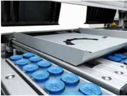
Posicionamiento de pieza automático mediante sistema de mesa trasera de ventosas.
