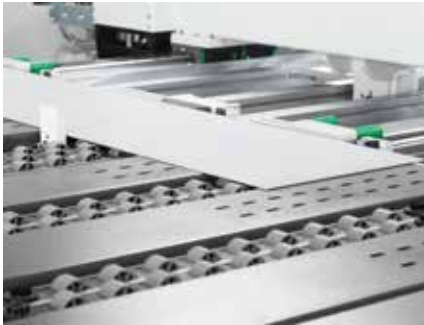
Precisión de plegado asegurada gracias a la alineación automática de las chapas suministradas.
