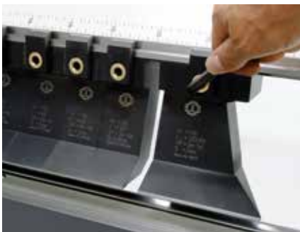
Herramientas con sistema de amarre rápido
