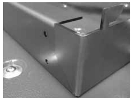
Flexibilidad ampliada, ya que la trancha de plegado se puede usar como tope.
