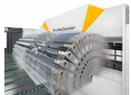
Plegado automático con tiempos de ciclo más rápidos. La pieza de trabajo no tiene que estar posicionada en los topes durante el proceso de plegado.
