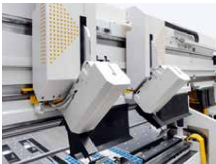
El cambiador de útiles automático coloca las herramientas de la trancha superior en posición.
