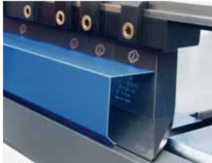
Herramientas segmentadas de la tranCHA superior con espacio libre frontal
