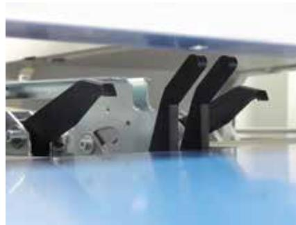
Gesicherte Biegequalität durch automatisches Ausrichten der Zuschnitte.
