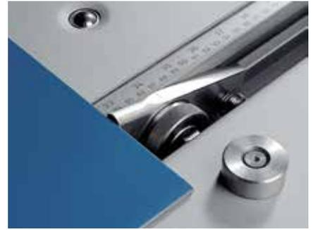
Das Hochhaltesystem führt auch dünne Bleche maßgenau zum CNC-Hinteranschlag.
