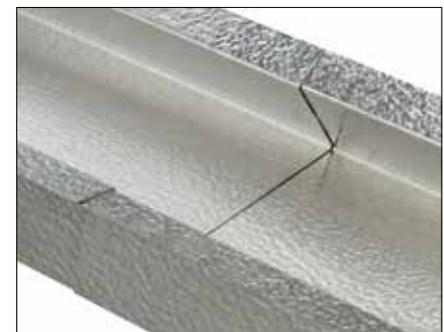
Exakte Paßgenauigkeit und kein Programmieraufwand bei ineinander steckbaren Profilen (konisch biegen).
