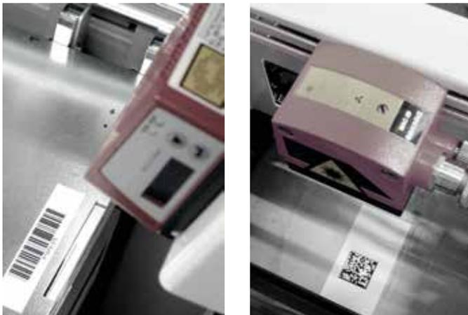
Automatischer Biegeprogramm-Aufruf bei MiniFeeder- oder Portal-Beladung durch Scannen eines Bar- oder QR-Codes auf der Platine.
