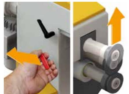
UnLock-Funktion öffnet die Wellen im Notfall.
