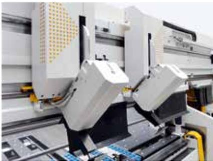
Der automatische Werkzeugwechsler setzt die Werkzeuge der Oberwange auf Position.
