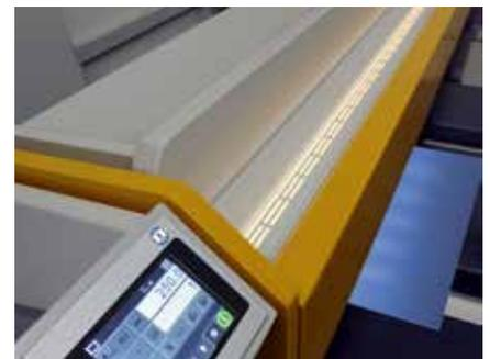
Komfortables Ausrichten der Platine nach Anriss mit LED-Schnittstellenbeleuchtung.
