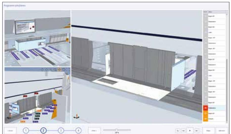
Die 3D Simulation zeigt den Biegeablauf und eventuelle Kollisionen. Neue Produkte lassen sich schon in der Konstruktion auf Machbarkeit prüfen.
