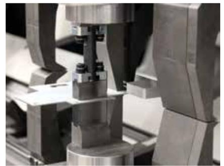
Entlang der Biegelinie lassen sich mehrere Biegestationen aufbauen. Komplexe Biegeteile werden dadurch in einem Durchlauf fertiggestellt.
