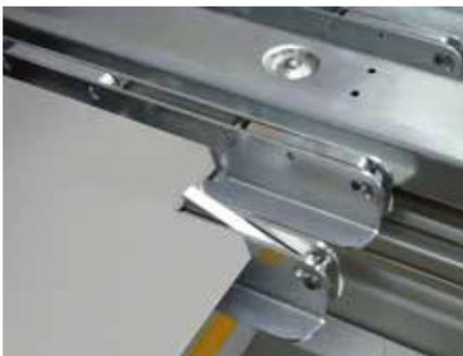
Flexibles Positionieren des Biegeteils. Einzelfinger lassen sich inaktiv schalten.
