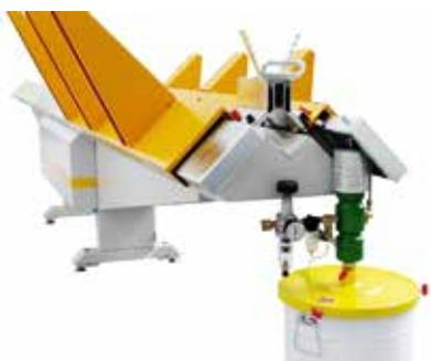
DuctZipper mit SealJet für maximal dichte Kanäle.
