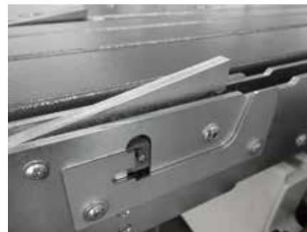
Bei nicht geraden Außenkanten der Platinen lassen sich einzelne Anschlagfinger inaktiv schalten.
