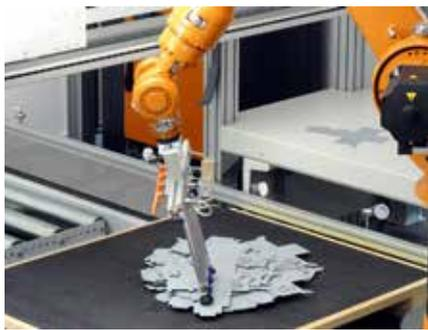
Die Roboterbeladung bietet maximale Flexibilität. Platinen können aus einer Schüttgutbox oder von Blechstapeln zugeführt werden.
