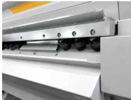
Für Wartungsarbeiten leicht zugängliche Umformrollen.
