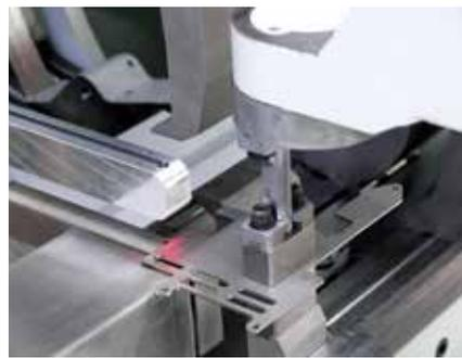
Vermessung der Platine durch einen Laser-Scanner.
