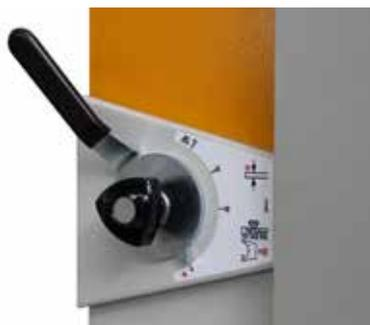
Hebel für die Schnittspaltverstellung an der PRIMEcut.
