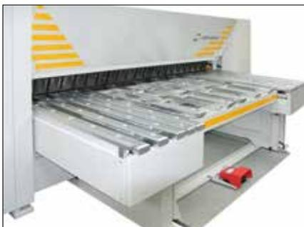
Anschlag-System auf Maximalmaß ausgefahren.
