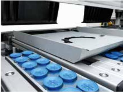
Automatisches Positionieren des Biegeteils durch den Saugeranschlag.
