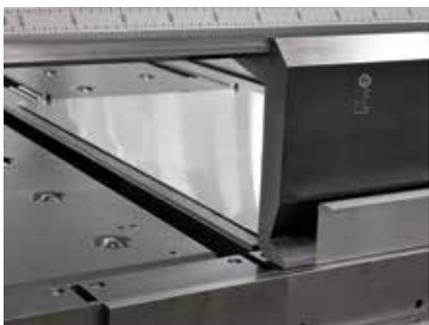
Beim Schwenkbiegen bleibt das Blech auf dem Anschlagtisch liegen. Ein Anheben der Biegeteile entfällt.
