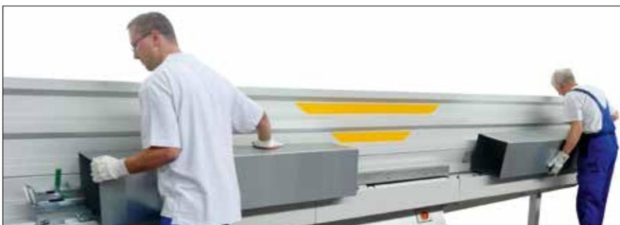
Verdoppelte Arbeitsgeschwindigkeit: Nachdem der erste Kanal entnommen ist, spannt der Bediener den Autopiloten auf den Folgekanal um und schon läuft der nächste Luftkanal durch die Maschine.
