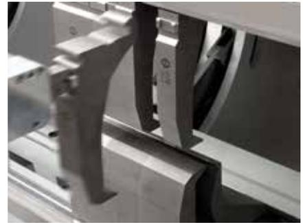
Das RAS MiniBendCenter ist das weltweit einzige Schwenkbiegezentrum für Kleinteile. Die Bleche werden automatisch zugeführt, ausgerichtet und vermessen. Der Werkzeugaufbau erfolgt automatisch.
