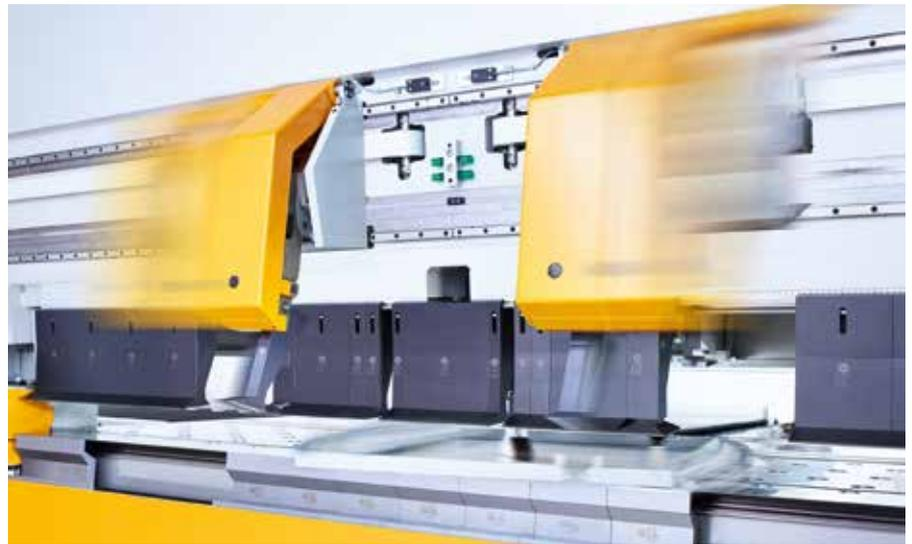
Vollautomatische Biegeabläufe: Positionieren, Drehen, Biegen und Werkzeugwechsel.
