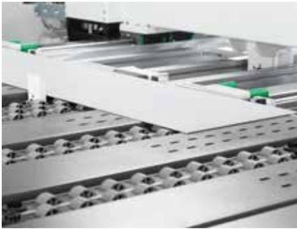
Gesicherte Biegequalität durch ein automatisches Ausrichten der zugeführten Blechzuschnitte.
