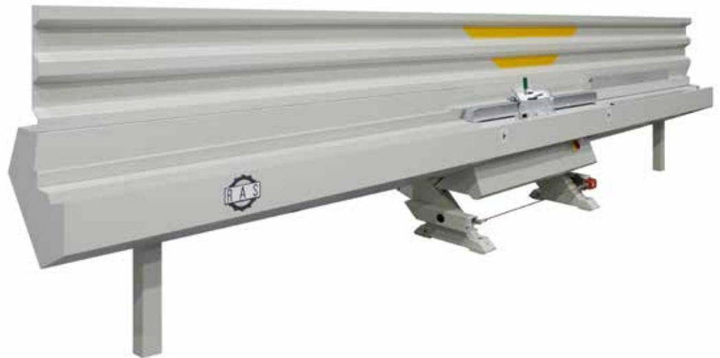
Der DuctZipper in L-Form ist speziell für große Kanalquerschnitte konzipiert. Die Arbeitslage ist um 45 Grad geschwenkt. Dadurch liegt der horizontale Schenkel des Kanals auf dem Tisch auf und der vertikale Schenkel ragt gerade nach oben. Griffmulden in der vertikalen Wand erlauben dem Bediener ein leichtes Halten und Führen des Kanals beim Durchlauf durch die Maschine.
