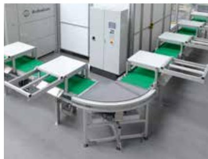
Bedarfsgerechtes Entladen der fertigen Biegeteile je nach Platzverhältnissen, Materialfluss und Empfindlichkeit der Biegeteile.
