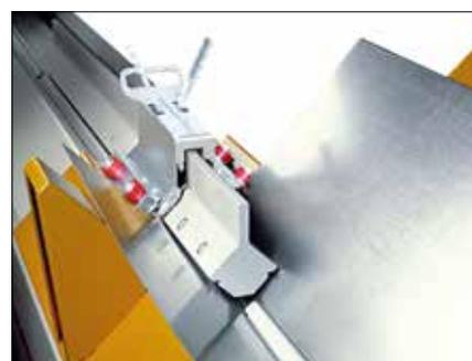
Autopilot und verstärkter Falzbalken beim DuctZipper RAS 20.12.
