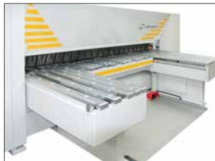
Anschlag-System eingefahren zur Positionierung kleiner Platinen.
