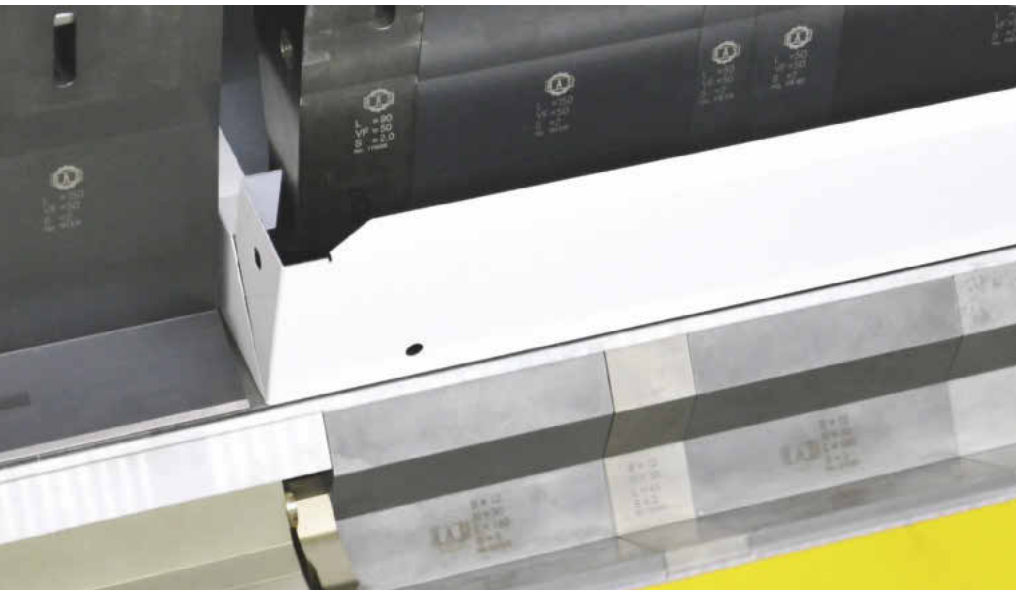
Exakt gebogene Teile sind sowohl für die Funktion und die Optik der Ultra-Gefrierschänke als auch für kurze Montagezeiten wichtig. Bilder: RAS Reinhardt
