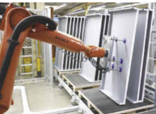
Die fertig gebogenen Blechteile stapelt ein Roboter so ab, wie die Arbeitsvorbereitung es vorgibt.
