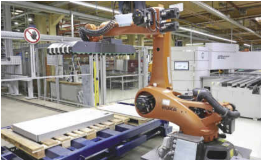
Der Roboter erhält seine Befehle von der Steuerung des Biegezentrums. Teachen oder Programmieren ist überflüssig.
