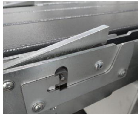
Bei nicht geraden Außenkanten der Platinen lassen sich einzelne Anschlagfinger inaktiv schalten.
