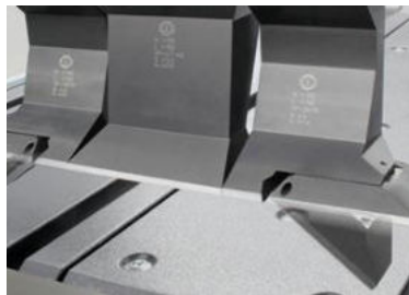
Die SnapTool-Eckwerkzeuge tauchen aus seitlich gebogenen Schenkeln automatisch aus.
