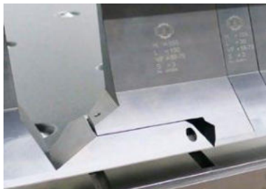
Die SnapTool-Eckwerkzeuge tauchen aus seitlich gebogenen Schenkeln automatisch aus.
