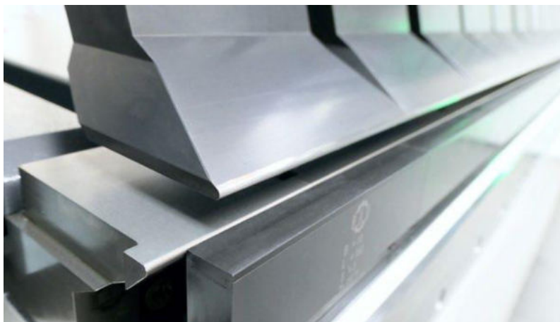
Manche Werkstoffe erfordern den Einsatz von Radiuswerkzeugen in der Ober- und Unterwange. Gepaart mit Biegewangenwerkzeugen mit Kunststoffeinsatz entstehen perfekte Oberflächen.
